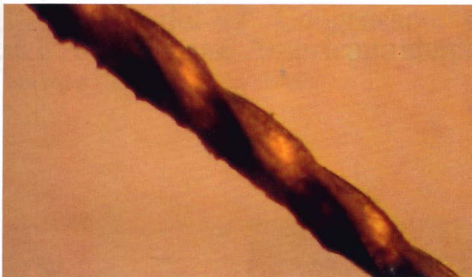
Fig. 3 - La sterilizzazione in autoclave a vapori di paraformaldeide ha determinato evidente usura
