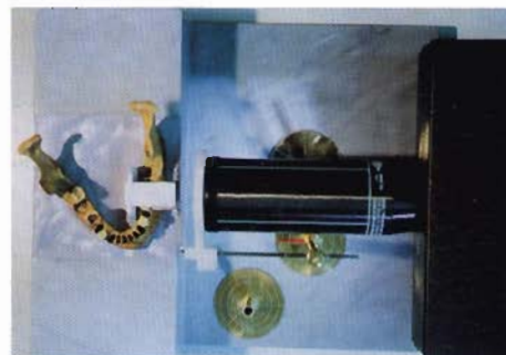
Fig. 3 - Proiezione ortoradiale: l'asta verticale è inserita nel cilindro centrale e l'ago indicatore fissato sul valore 0^\circ .
