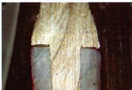
Fig. 18 - Campione allo stereomicroscopio di perno moncone passivo cementato con Boston Post Cement. Grado di microinfiltrazione = 1.
