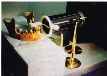
Fig. 2 - Il dispositivo ideato, nella fase di esecuzione di una proiezione ortoradiale. È ben evidente come siano rispettati i principi di geometria proiettiva della tecnica dei raggi paralleli.
