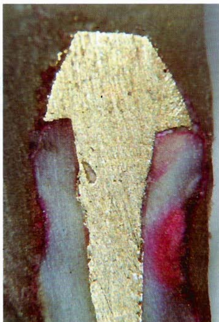
Fig. 20 - Campione allo stereomicroscopio di perno moncone tradizionale cementato con ossifosfato di Zn. Grado di microinfiltrazione = 4.
