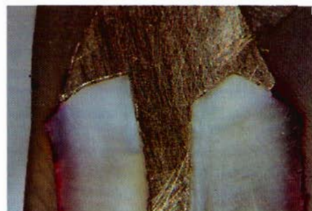
Fig. 19 - Campione allo stereomicroscopio di perno moncone passivo cementato con CR Inlay. Assenza di microinfiltrazione.
