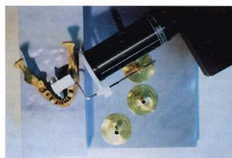
Fig. 5 - Proiezione eccentrica dal lato distale: l'asta verticale posta nel cilindro di destra è ruotata sul piano orizzontale affinché l'ago risulti sul valore -30^\circ .
