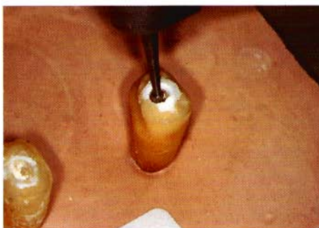
Fig. 2 - Con una fresa a rosetta si è proceduto a creare un pozzetto dove posizionare i vari solventi da testare.
