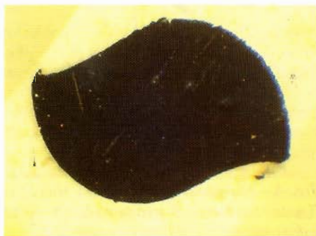
Fig. 1 - Sezione trasversale di un Mac File: si nota la presenza di due lame contrapposte.
