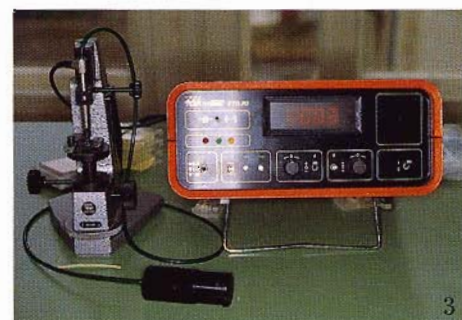
Figg. 2 e 3 - Apparecchiatura utilizzata per la misurazione dei diametri degli strumenti canalari.
