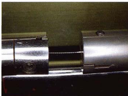
Fig. 4 - Apparecchiatura utilizzata sia per il test di resistenza alla frattura in torque che per il test di resistenza alla deviazione angolare.
