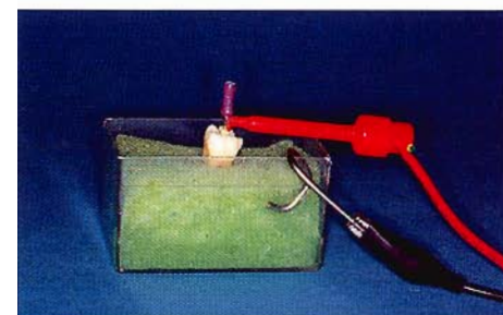
Fig. 2 - Dispositivo per la valutazione in vitro del localizzatore elettronico.
