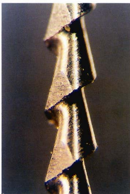
Fig. 2 - Safety Hedstroem: particolare ingrandito delle lame a 25 ingrandimenti.
