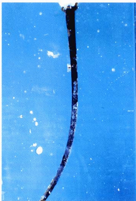
Fig. 3a - Gruppo 1: Canali artificiali in resina prima della strumentazione con frese di GG. E' stato inserito del colorante per meglio evidenziare l'andamento originale delle curvature.
