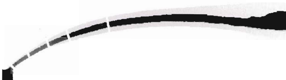
Fig. 5 - Safety Hedstroem, esempio di sovrapposizione. In nero l'area originale del canale, in grigio quella finale. Sono anche visibili i limiti delle quattro aree prese in esame. In questa immagine si osserva come sia stata ben rispettata la superficie interna della curva.
