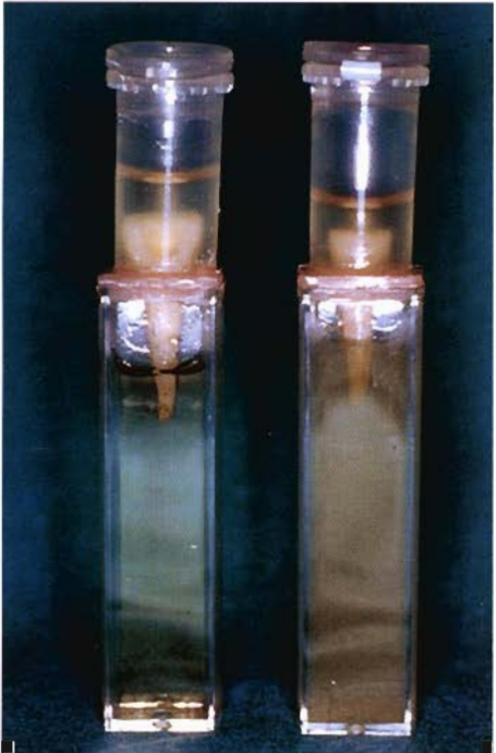
Fig. 4 - Intorbidimento, e quindi avvenuta infiltrazione, del medium nel campione di destra rispetto a quello di sinistra dove il medium è ancora sterile.
