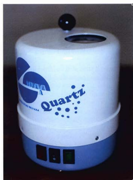
Fig. 2 - Sterilizzatrice a palline di quarzo utilizzata nello studio.
