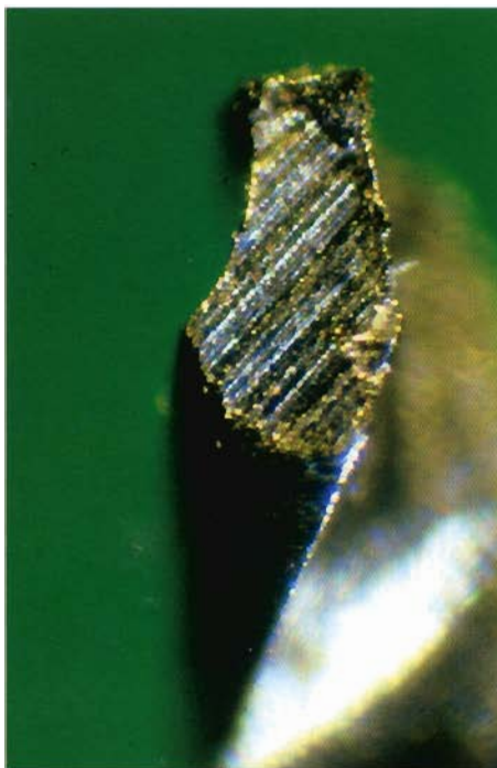
Fig. 1 - Immagine al microscopio ottico della punta di uno strumento Quantec SC.
