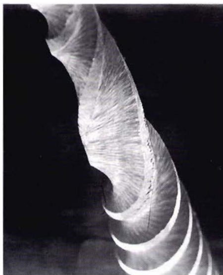
Fig. 1 - Immagine al SEM di strumento canalare al nichel-titanio con evidente deformazione plastica in virtù di stress torsionali superiori al limite elastico. Come per l'acciaio inossidabile (anzi a maggior ragione per il nichel-titanio) lo strumento va immediatamente scartato.
