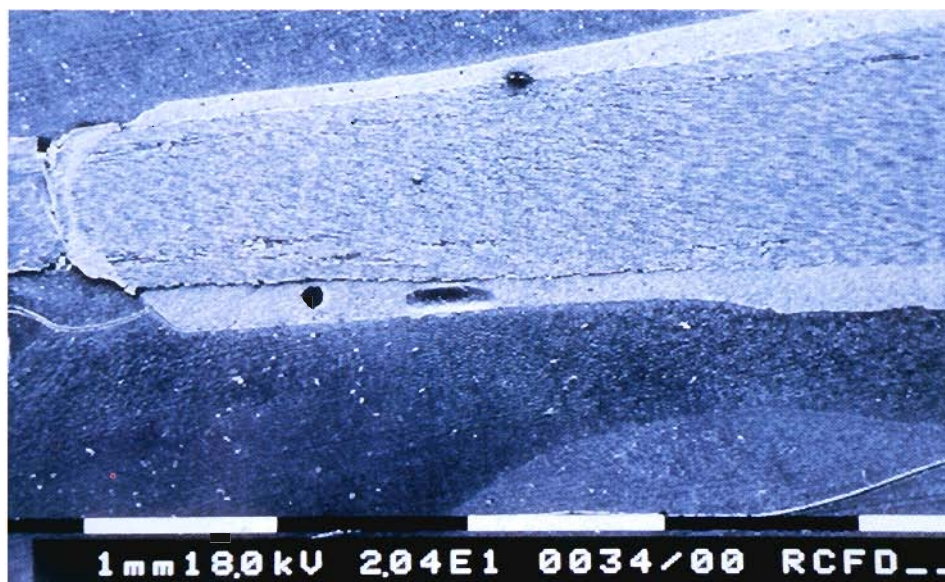
Fig. 22 - Immagine al SEM, a basso ingrandimento: perno Tech 2000 immerso nel composito Clearfil Cavex Core autopolimerizzabile.
