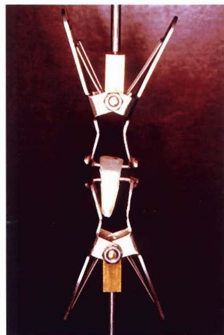
Fig. 1 - Micropinza a molla per l'afferraggio del campione.
