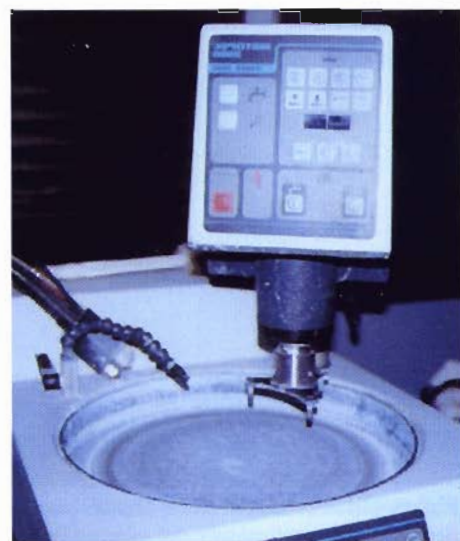
Fig. 4 - Lappatrice utilizzata per rifinire la superficie dei campioni da sottoporre a osservazione microscopica.
