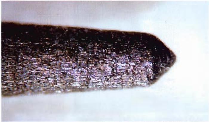
Fig. 3 - Ingrandimento 10 x allo stereomicroscopio del perno Tech 2000 (Ø 12), particolare della punta.
