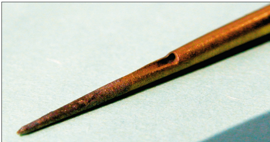
Fig. 12 - Il foro di irrigazione delle punte BUC 3 e 3A (SybronEndo, Orange, CA, USA) è posizionato appena al termine della parte lavorante.
