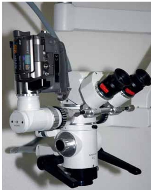
Figura 2 Microscopio operatorio con telecamera per ripresa video.
