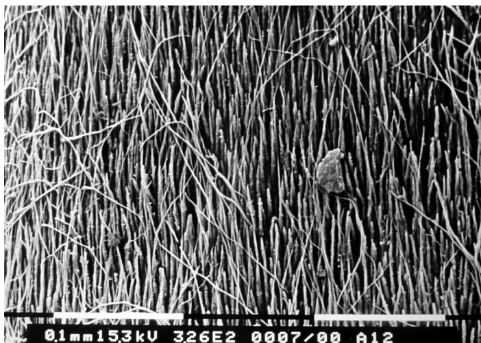
Fig. 1 - 326x, distretto coronale, gruppo A. Zaffi tronco-conici ad andamento longitudinale rispetto all'asse del perno cementato.
